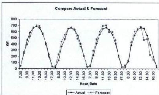
รูปที่ 7 เปรียบเทียบกำลังไฟฟ้าจริง กับ กำลังไฟฟ้าจากการพยากรณ์
