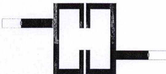
รูปที่ 7 รูปร่างวงจรกรองแบบเด่นอินพีดานซ์แบบขั้น
